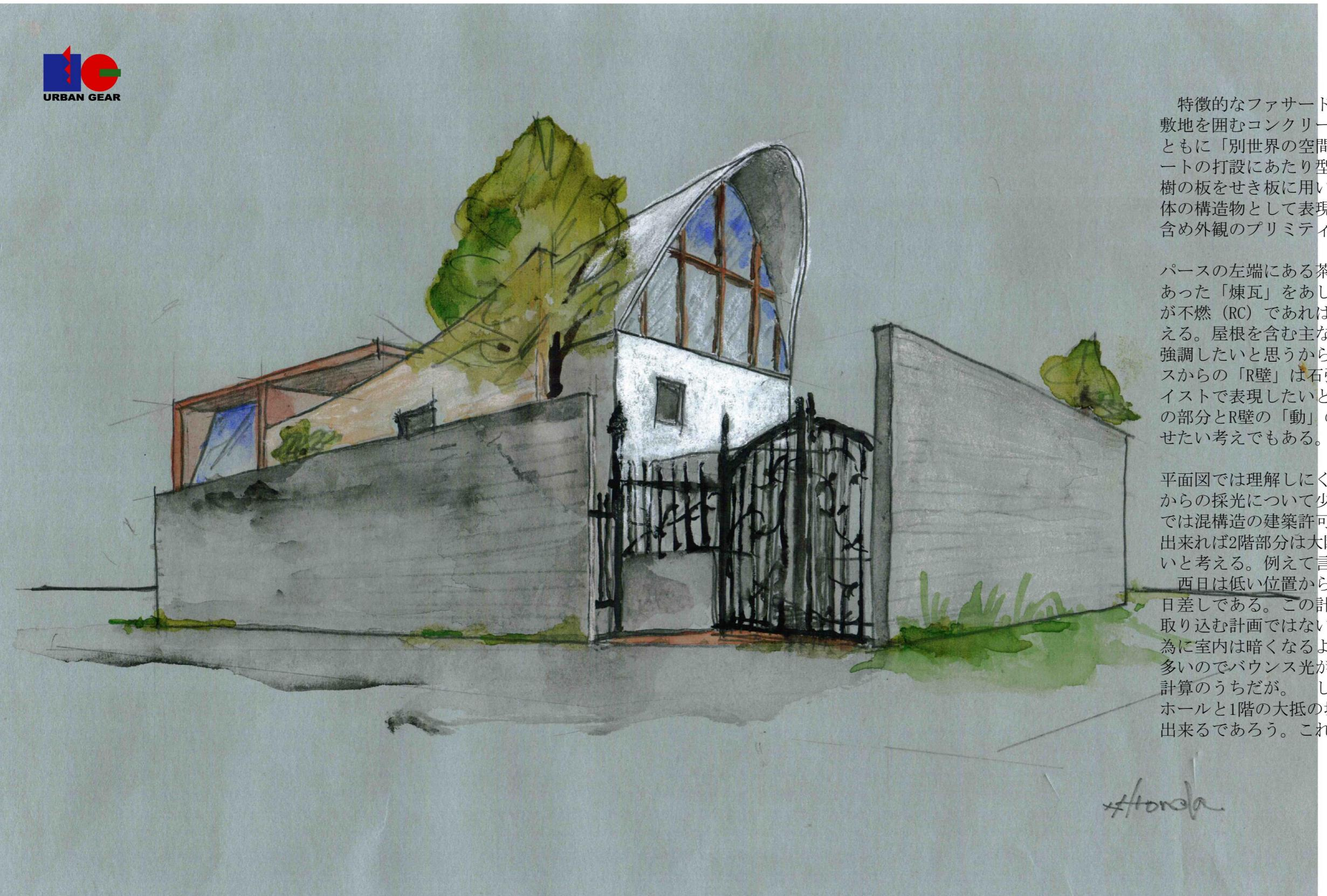
特徴的なファサードは曲面と平面で構成されている。敷地を囲むコンクリートの塀は外部からの視線を遮るとともに「別世界の空間」を構築する。一般的にコンクリートの打設にあたり型枠用パネルを用いるが、私は針葉樹の板をせき板に用いて木目を表す事によって敷地を一体の構造物として表現したいと考える。これは内部を含め外観のプリミティヴな素材を強調させる意図がある。
